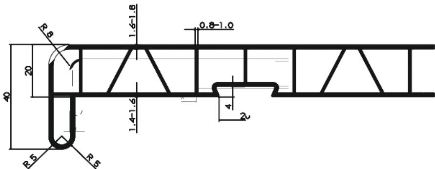
Конструкция ребер - обеспечивает подоконнику повышенную прочность.
